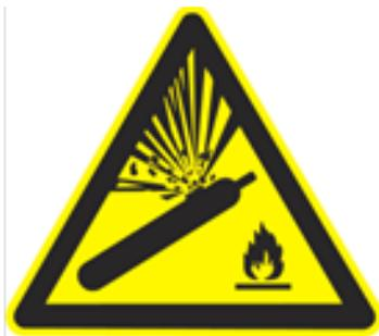
Dieses Symbol (explodierende Druckgasflasche) muss vor dem Betreten eines Gefahrenbereiches „Druckgasflasche“ gut sichtbar angebracht werden.
